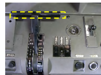
運転士異常時列車停止装置 (ハンドルから手を離すと列車が自動停止)
