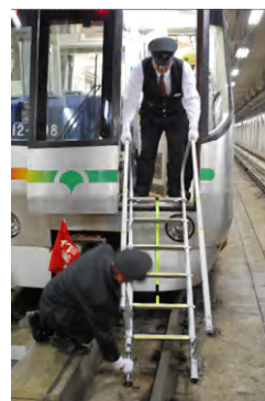
▲ 車両設置の非常梯子
