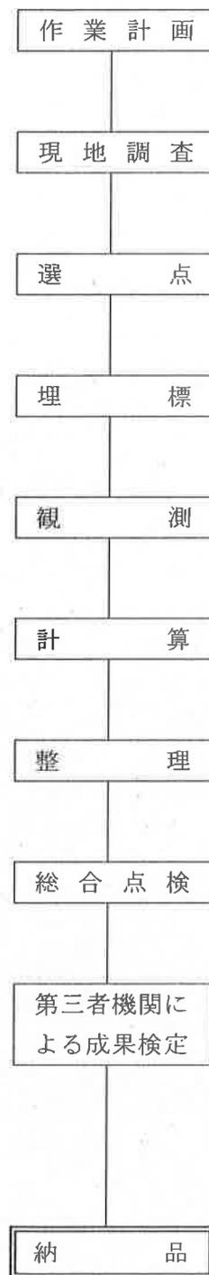
(3) 地形測量作業工程図
