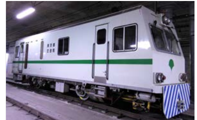
現在導入している保守用車両(軌道検測車)
