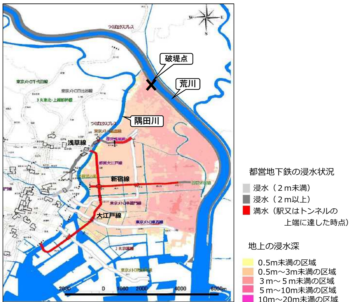
図表 3-24 荒川右岸9.5km破堤による都営地下鉄の浸水状況
