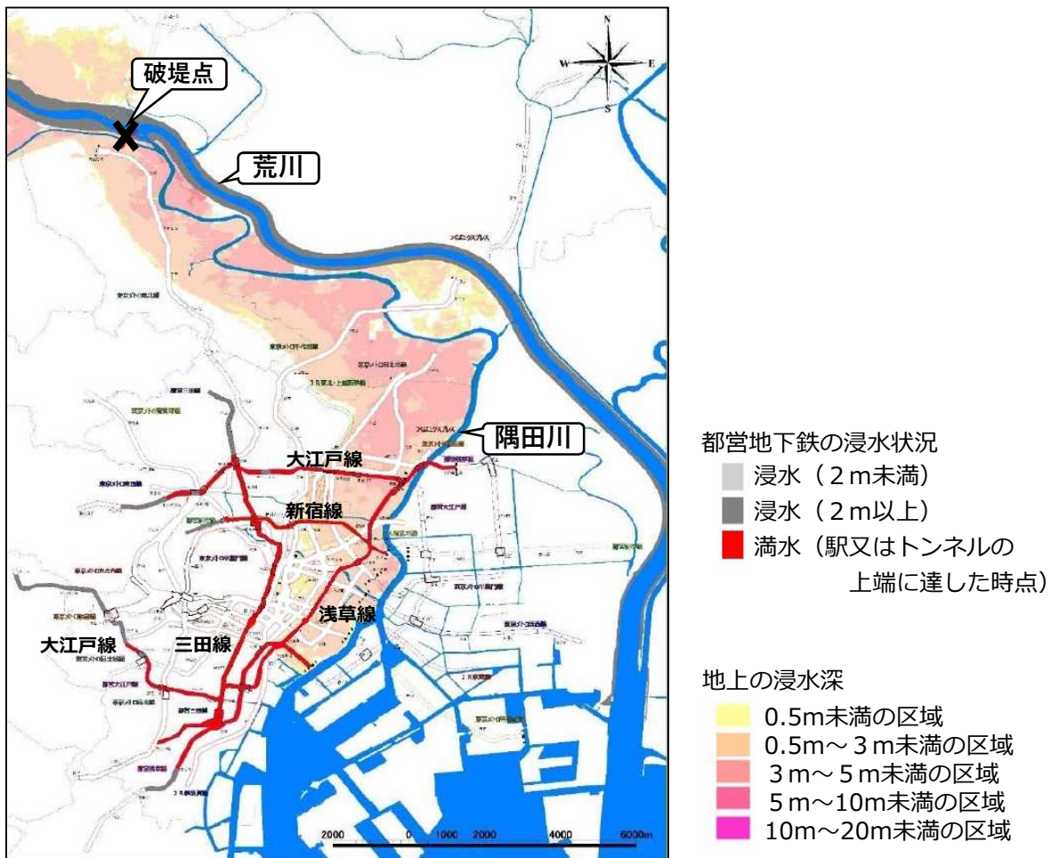
図表 3-18 荒川右岸21km破堤による都営地下鉄の浸水状況
