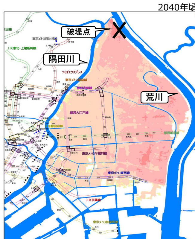
図表 4-26 対策後 (右岸9.5km破堤)
