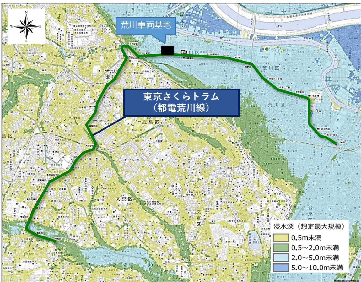
図表 6-5 浸水予想区域図等の重ね合わせ図と東京さくらトラム（都電荒川線）路線図
