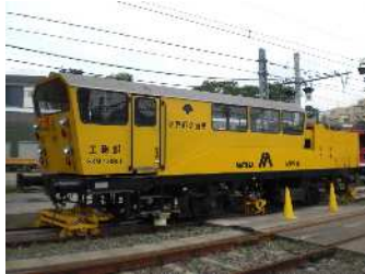
軌道変位検査（軌道検測車）
