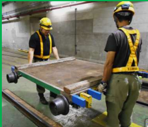
重量が重い軽便トロを運ぶ作業職員 (重量は40キロから100キロあり)
