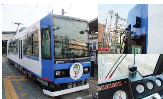
ドライブレコーダー搭載車両（側面・前方カメラ）
