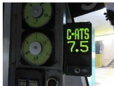
▲C-A T Sの運転台表示器
