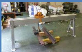
▲脱線防止ガード等をつり上げる 山越器（全体図）
