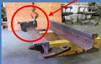
▲脱線防止ガード等をつり上げる 山越器（拡大図）
