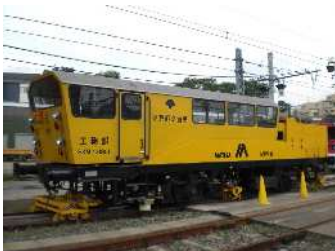
▲軌道変位検査（軌道検測車）
