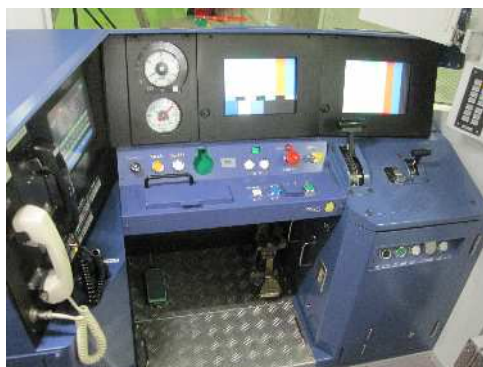
▲ＩＴＶ車上モニター装置（大江戸線車両）
