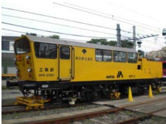
▲軌道変位検査（軌道検測車）
