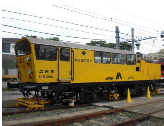
▲軌道変位検査（軌道検測車）
