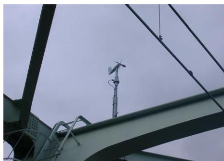
▲新宿線荒川橋りょう部に設置している風速計
