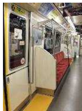
▲大型袖仕切り板（大江戸線）
