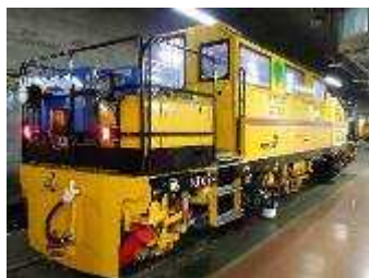
▲軌道変位検査（軌道検測車）
