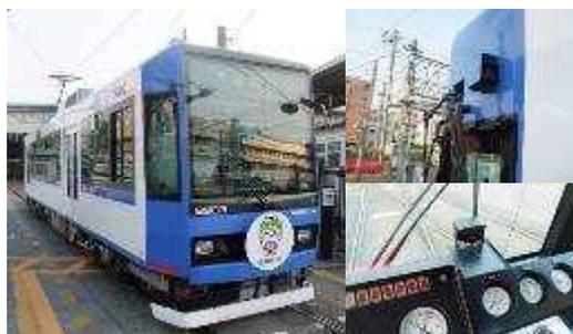
▲ドライブレコーダー搭載車両（側面・前方カメラ）
