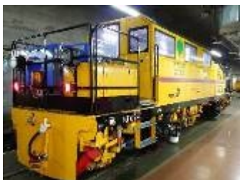
▲軌道変位検査（軌道検測車）
