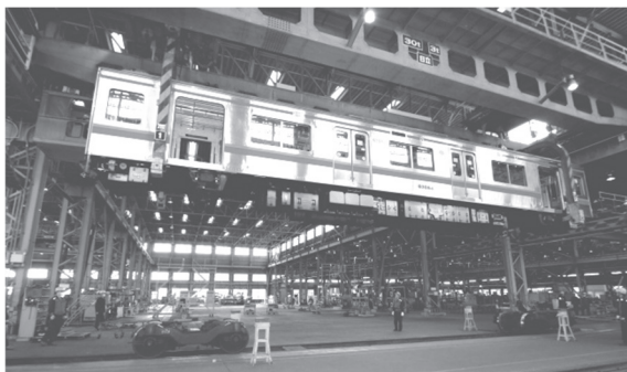
【全般・重要部検査 志村車両検修場】
