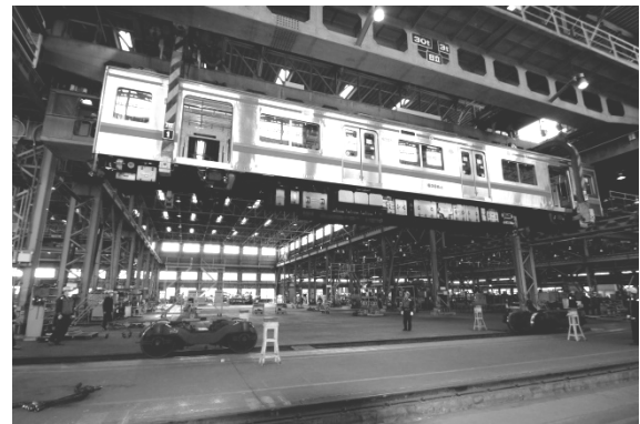
【全般・重要部検査 志村車両検修場】
