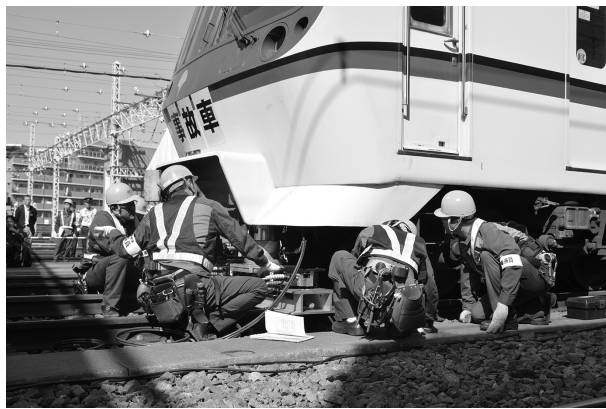
【車両の脱線復旧作業】
