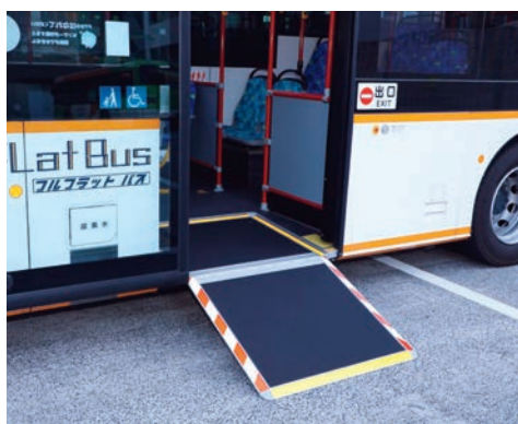
▲車いすスロープ
