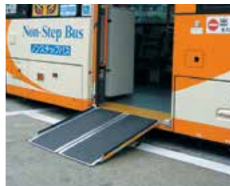
▲車いすスロープ
