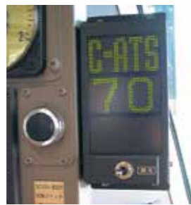
▲C-ATS運転台の表示器
