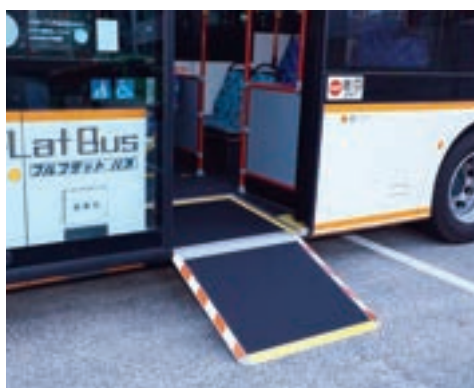
▲車いすスロープ
