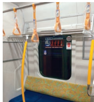
▲優先席、低い吊り手、低い荷棚、つかまりやすい縦の手すり
