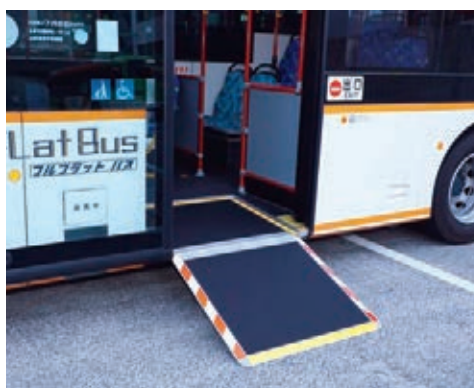
▲車いすスロープ
