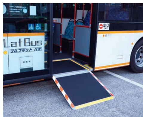
▲車いすスロープ
