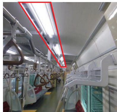
▲浅草線5500形車内LED灯
