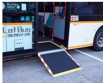
▲車いすスロープ
