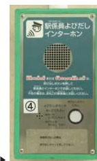
駅係員呼出インターホン▶
