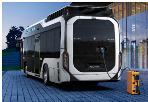
燃料電池バスと外部給電器の接続
