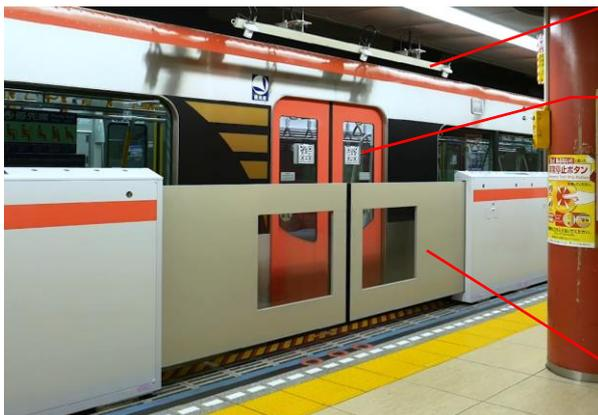
QRコードを車両ドアに貼り、ホーム上のカメラ（読み取り装置）で車両ドア数、編成車両数などの情報やQRコードの動きを検知します。
