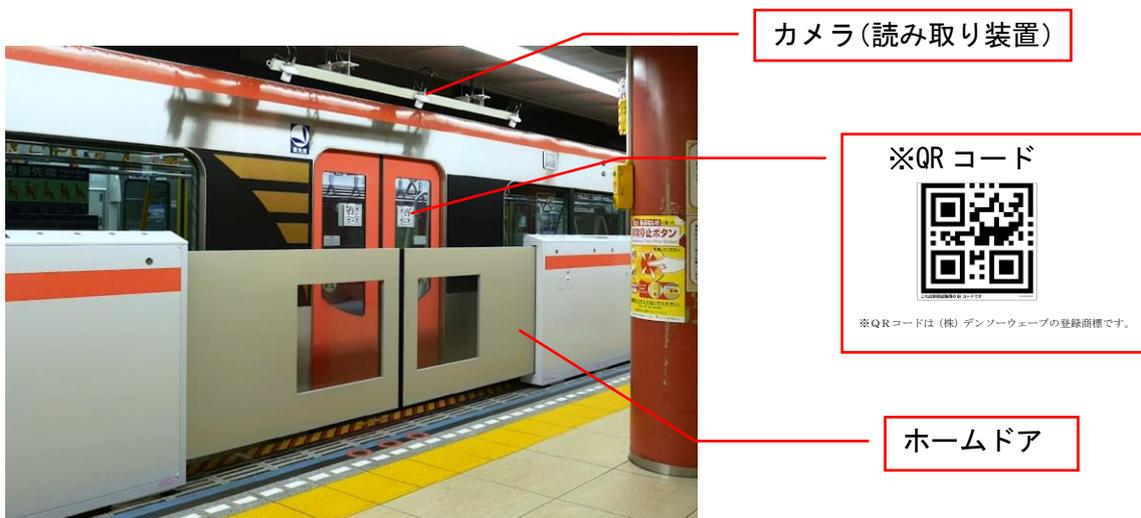
QRコードを車両ドアに貼り、ホーム上のカメラ（読み取り装置）で車両ドア数、編成車両数などの情報やQRコードの動きを検知します。⇒車両ドアの開閉に合わせてホームドアを開閉します。
