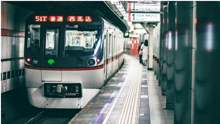
最後の1本となった5320編成 VVVF制御方式、LED方式による行先表示器を導入、 平成初期の最先端技術を採り入れた
