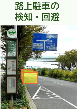
路上駐車への検知・回避 バス停付近に路駐車車両があることで、進入・発車時に手動走行が必要
