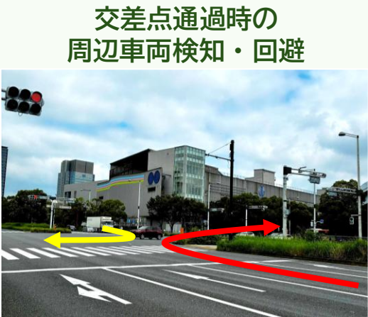
交差点通過時の周辺車両検知・回避 大型車両接近や対向右折車の検知に伴って、バスが減速・停止してしまうため、手動走行が必要
