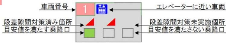
※ 目安値: ホームと車両の段差が3cm以下(乗車率100~150%程度)、隙間が7cm以下(混雑状況により、段差・隙間の寸法は変動します。)
